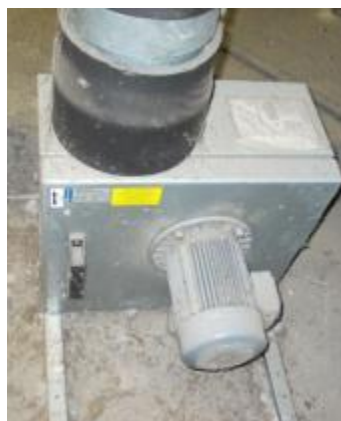
Slika 13: Centrifugalni ventilator Vir: lastni vir.
